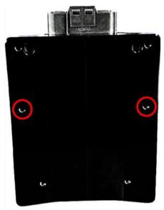
USE SMALLER BOLTS TO FASTEN THE CONTROLLER TO THE BIKE.
